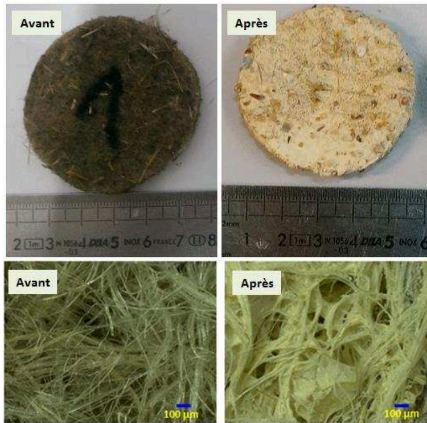
Figure 5-5. Photos et vues au microscope du géotextile avant et après l'essai de filtration
