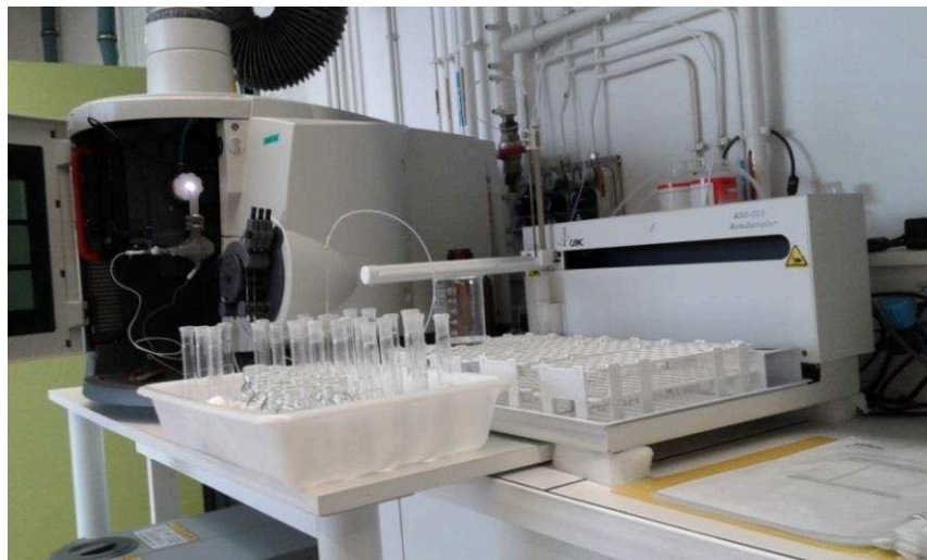
Figure 3-9. Ionisation induite par plasma – Inductively Coupled Plasma (ICP-OES)
