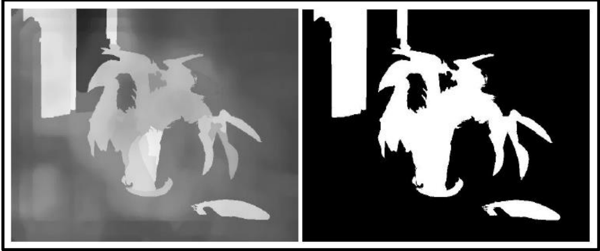
Figure 29: Exemples de FSM (à gauche) et le masque d'extraction de la saillance (à droit).
