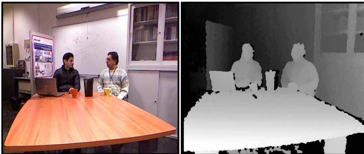
Figure 10: Images couleur et profondeur capturées respectivement par la camera 2D et IR de la Kinect.
