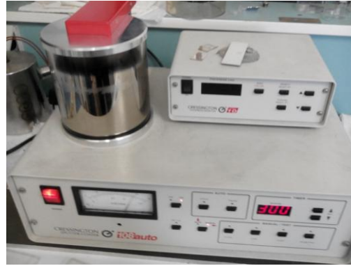
Figure 2.6 : Métalliseur pour la pulvérisation cathodique de dépôt platine sur les lames de Zirconium
