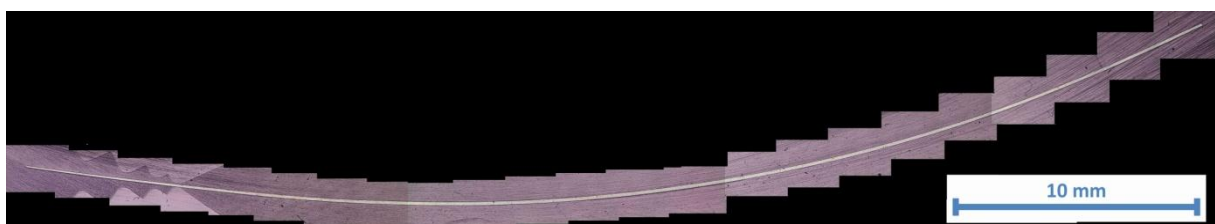
Figure 2.14 : Profil de la lame de déflexion J1 (150 µm, 450°C) reconstitué
