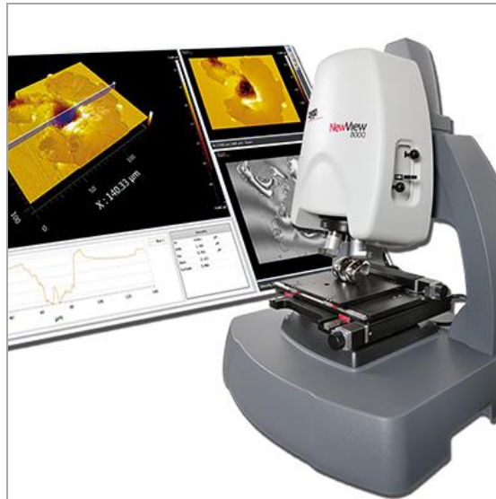
Figure 4.19 : Microscope interférométrique Zygo New View 8000® utilisé
