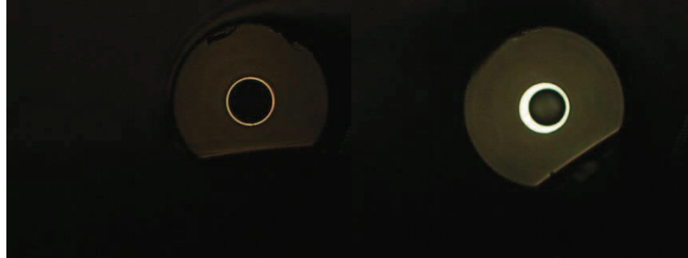
Figure II-13: Photographies prises au microscope optique en transmission de défauts observés lors de la fabrication de fibres optiques par le procédé poudre
