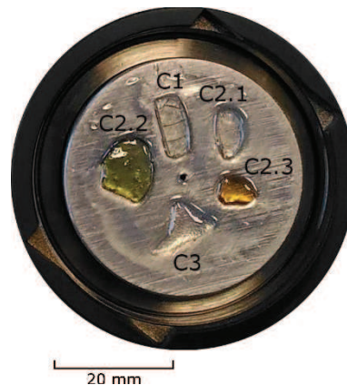
Figure II-10: Echantillons de verres de compositions C1, C2.1, C2.2, C2.3 et C3 utilisés pour les mesures de transmission et d'ellipsométrie
