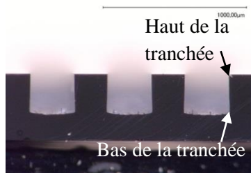
a) Image en microscopie optique du profil d'une tranchée de 300 \mu\text{m} de large gravée avec une couche de masquage en résine.
