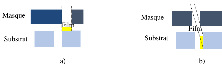
Figure V.5. a) Principe du dépôt localisé par la technique de masquage par ombrage a) à incidence normale ou b) à incidence oblique.
