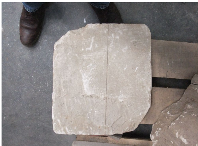
a. dalle sciée de toiture
