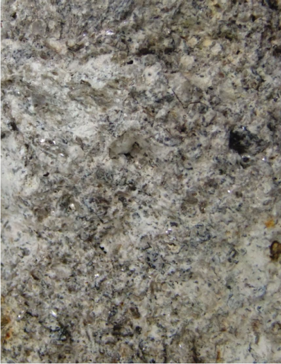
Fig. 101 : Grès feldspathique à grains grossiers et à muscovite (B2005.9.9506.83, cliché : F. Delencre 2017).
