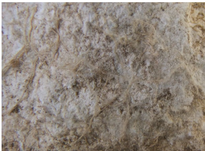
Fig. 274 : Référentiel pétrographique des matériaux de construction lithiques à Ahuy « Les Presles ». Pierre d'Asnières (cliché : F. Delencre 2016).
