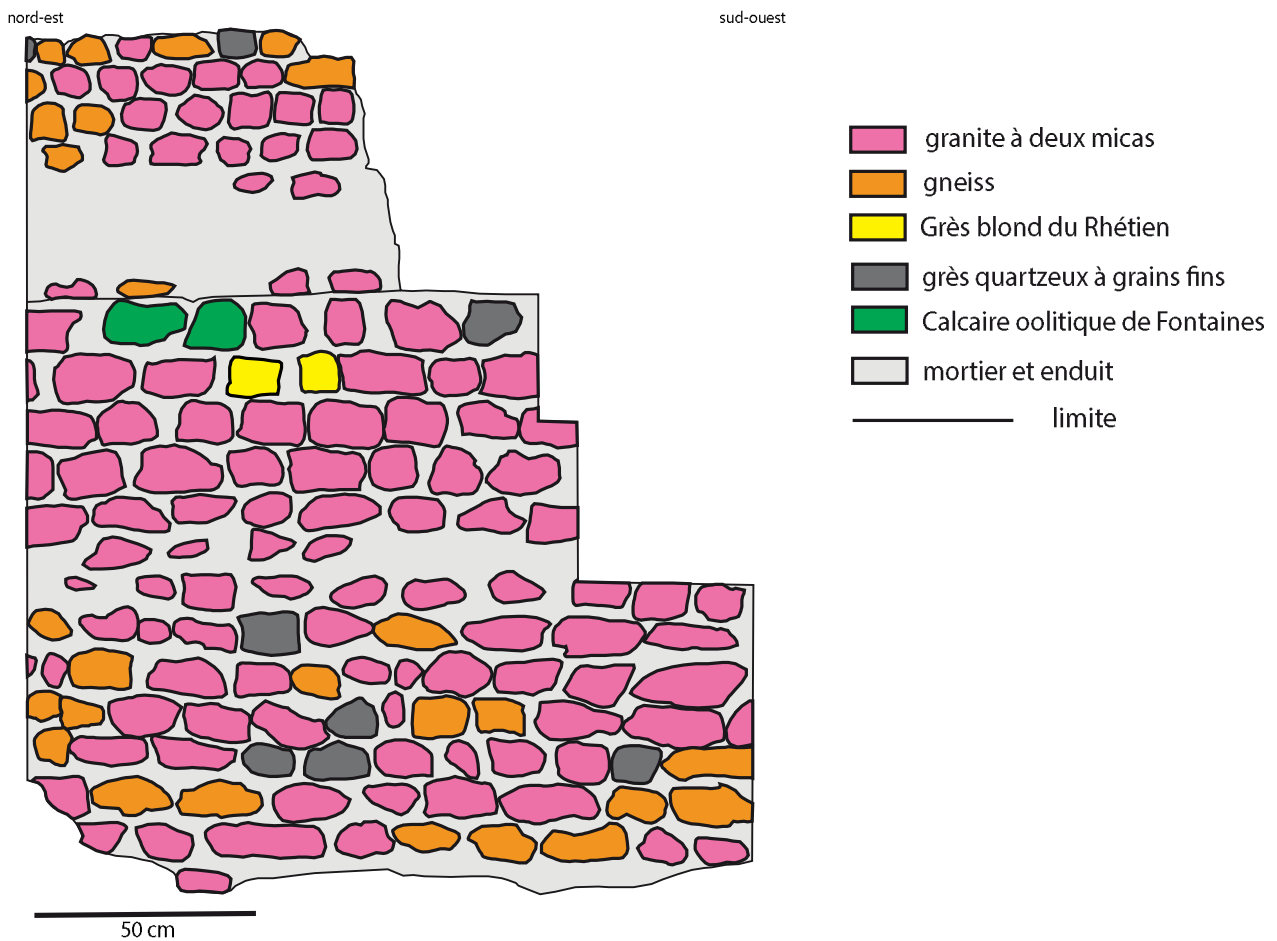
Fig. 189 : Détermination pétrographique des constituants du mur [10] appartenant à la phase de construction de l'édifice monumental (DAO : F. Delencre 2017).
