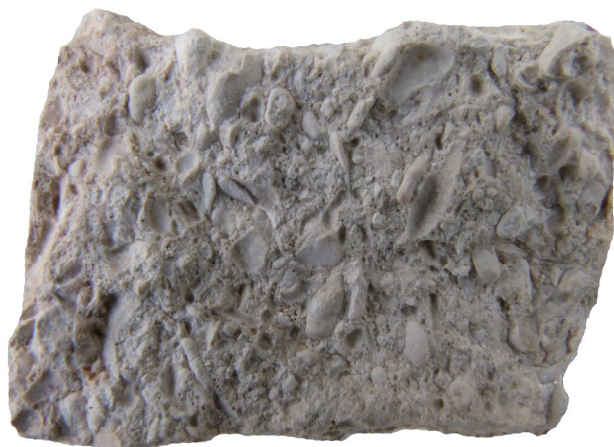
Fig. 256 : Référentiel pétrographique des matériaux de construction lithiques à Mâlain-Mediolanum. g) tuf calcaire (cliché : F. Delencre 2009) ; h) calcaire blanc crayeux faciès fin (cliché : F. Delencre 2015) ; i) calcaire blanc crayeux faciès grossier (cliché : F. Delencre 2015).
