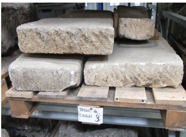
Fig. 239 : Référentiels architectural et pétrographique des matériaux de construction lithique du fanum de Crain. a) dalle sciée de toiture (cliché : F. Delencre 2016) ; b) chapiteau corinthien (cliché : F. Delencre 2016) ; c) blocs monumentaux du tronc (cliché : F. Delencre 2016) ; d) faciès pétrographique du Calcaire de Tonnerre (cliché : F. Delencre 2016).
