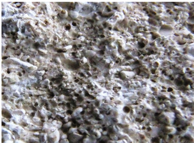
Fig. 252 : Référentiel pétrographique des matériaux de construction lithiques à Langres- Andemantunum . Oolithe miliare (Place des États-Unis, cliché : F. Delencre 2017).
