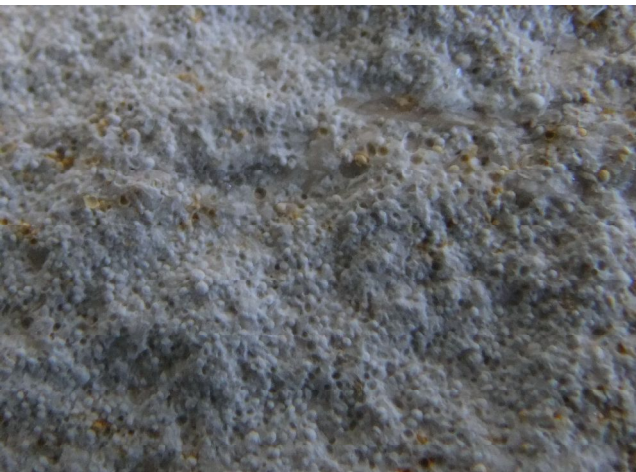
Fig. 105 : Référentiel pétrographique des matériaux de construction lithiques. m) grès vacuolaire à grains grossiers (sans localisation, cliché : F. Delencre 2017) ; n) grès feldspathique à grains grossiers et à muscovite (B2005.9.9506.83, cliché : F. Delencre 2017) ; o) Calcaire oolitique de Fontaines (sans localisation, cliché : F. Delencre 2015) ; p) biosparite à orbitoline (B2003.7.6928.3, extrait de Garcia et Petit 2005, p. 252).
