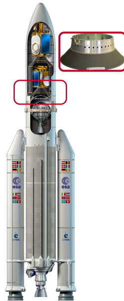
FIGURE 3.20 – Illustration du Lanceur Ariane 5 et de l'un de ses Adaptateur Charge Utile [ Ariane 5, User's Manual 2011 ]
