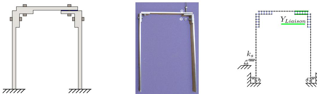
FIGURE 2.21 – Schéma, photo et modèle EF du portique muni d'une seule liaison lorsque celle-ci est située sur la poutre horizontale
