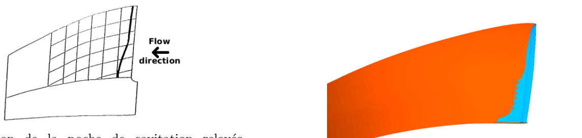
(b) Visualisation de l'isosurface  a 10% du taux de vide  a d ebit nominal et  a NPSH = 10.5 m .
