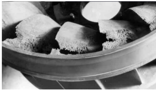
FIGURE I.3 – Érosion de cavitation sur les aubes d'une turbine Francis [Brennen, 1994].
