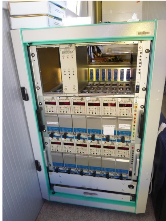
Figure 2.4 : Photos du dispositif utilisé pour la mesure de l'activité en ^{214}\text{Po} sur les grilles de diffusion par spectrométrie alpha.
