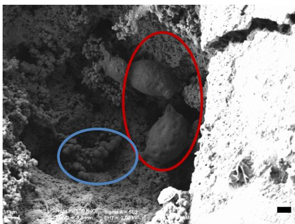
**Figure 14 : Image MEB (X 5000) d'une surface de titane grade 5 électro-érodées 'taille 4' sur laquelle des levures (cercle rouge) et des bactéries (cercle bleu) sont visibles. La barre d'échelle correspond à 1 µm.**
