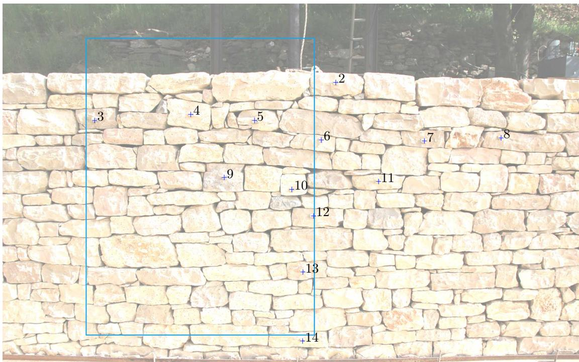
Figure 4.28 – Représentation de la position des capteurs à câble (+) sur le parement et du champ des caméras utilisées pour l'analyse d'images 3D (rectangle —).
