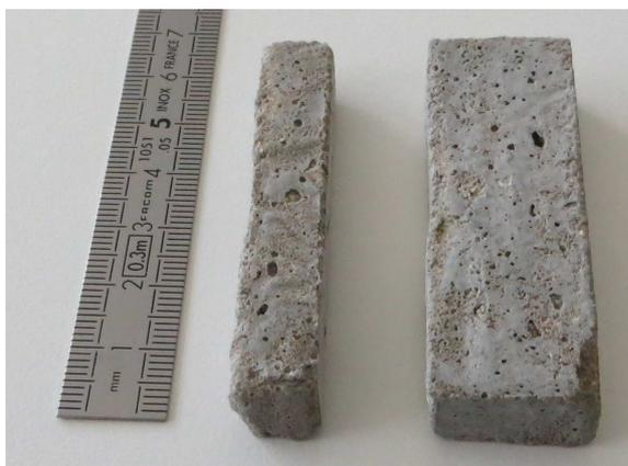
Figure 4.3 – Briques en mortier de ciment employées pour le modèle physique 2D.
