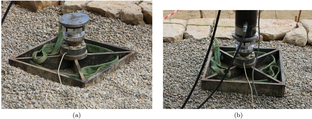
Figure 4.26 – Application de la surcharge ponctuelle : a) plaque de charge à la fin de l'essai 3; b) système plaque de charge, peson, rotule et vérin.
