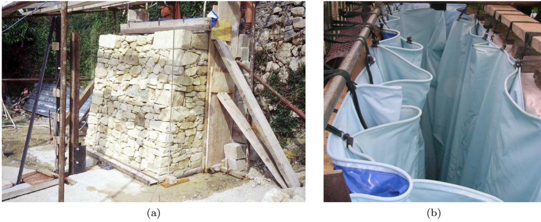
Figure 1.22 – Campagne expérimentale menée par Villemus *et al.* (2007) : a) mur 1 (calcaire) ; b) détail de la piscine de chargement à l'amont du mur.
