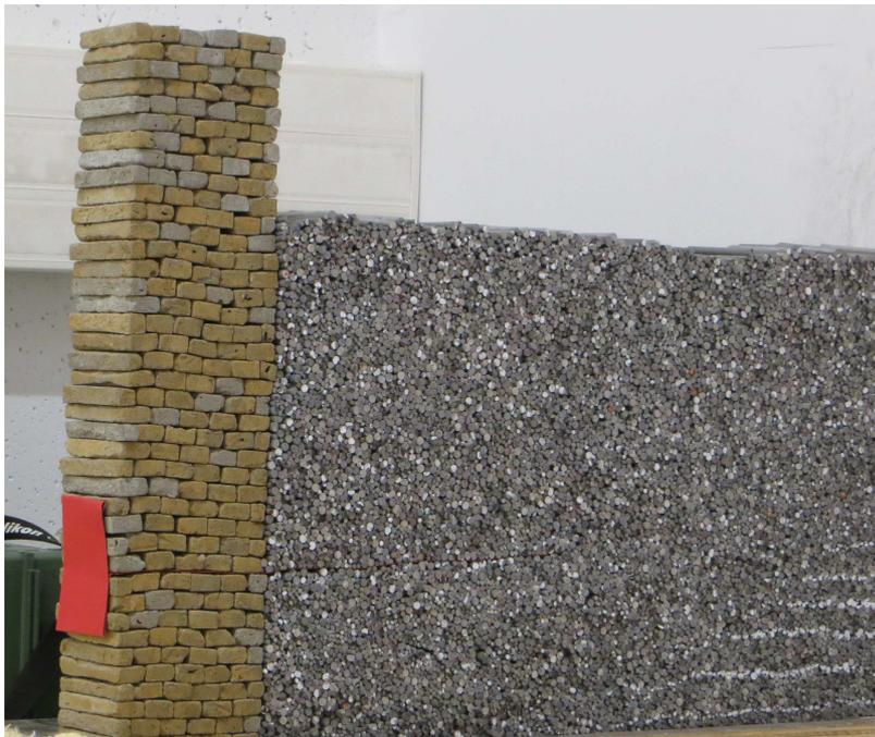
Figure 4.4 – Ancrage du clou sur le parement aval du mur (en rouge) – mur n° 21.
