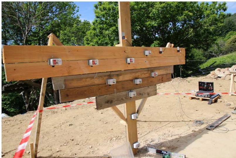
Figure 4.27 – Capteurs à câble utilisés pour mesurer les déplacements du parement.
