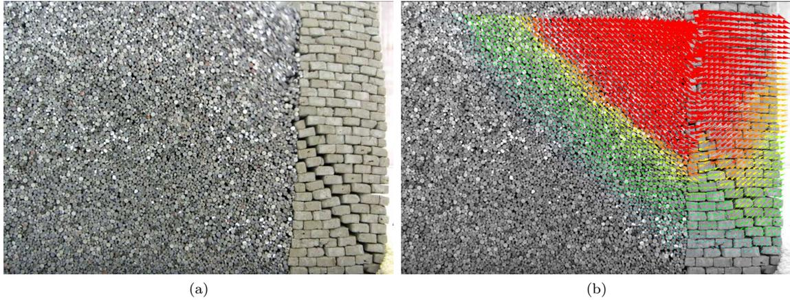
Figure 4.8 – Cinématique de la rupture du mur n° 2 : a) rupture interne de la maçonnerie sèche ; b) rupture dans le sol obtenue par corrélation d'images.
