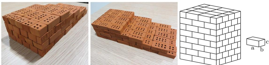
Figure 4.13 – Appareillage à joints croisés dans deux directions de l'espace, laissant les joints des lits de pose continus : a-b) appareillage réalisé avec les briques de terre cuite de l'étude c) rappel de l'appareillage de Le (2013).
