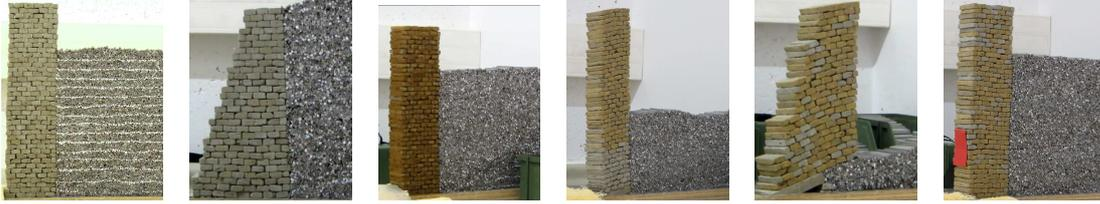
Figure 4.1 – Aperçu des configurations d’essai, de gauche à droite : configuration de référence ; mur à parement aval incliné ; mur jointoyée ; mur à lits inclinés ; mur à parement aval et lits inclinés ; mur cloué.
