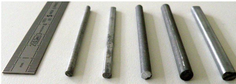
Figure 4.2 – Rouleaux de Schneebeli. De gauche à droite : rouleau de 3 mm de diamètre, rouleau de 3 mm de diamètre maté, rouleau de 4 mm de diamètre, rouleau de 5 mm de diamètre et rouleau de 5 mm de diamètre maté.
