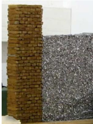
Figure 4.6 – Mur en maçonnerie hourdée, mur n° 16.
