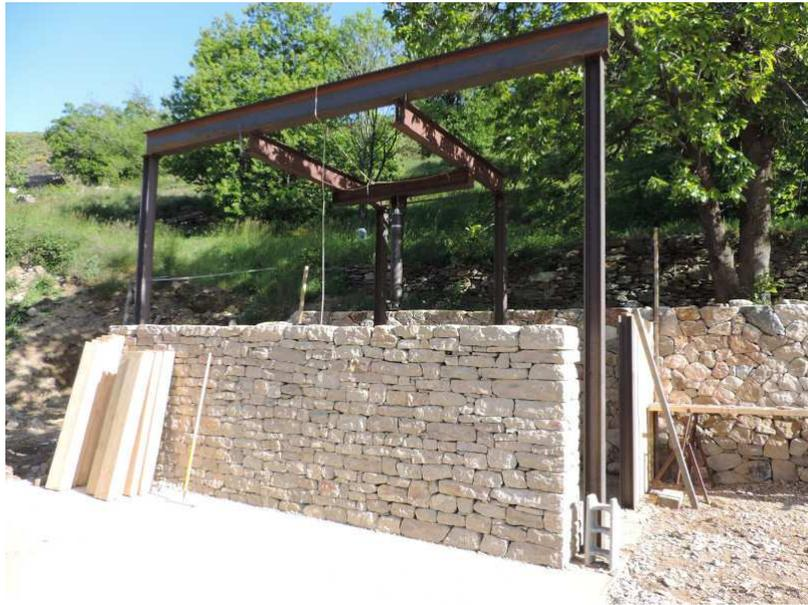
Figure 4.22 – Mur en calcaire de la campagne d'essai à l'échelle 1.
