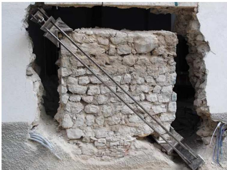
Figure 1.29 – *Diagonal compression test* réalisé dans un mur existant d'après Borri *et al.* (2011).
