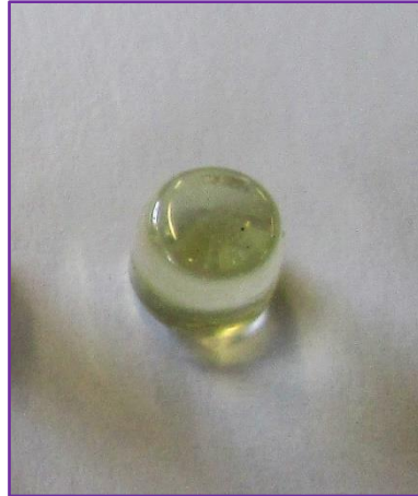
Figure V-14 : photo de la déformation du verre PC60.20 après 35 minutes de recuit à 755°C. La forme de départ est un cylindre droit.
