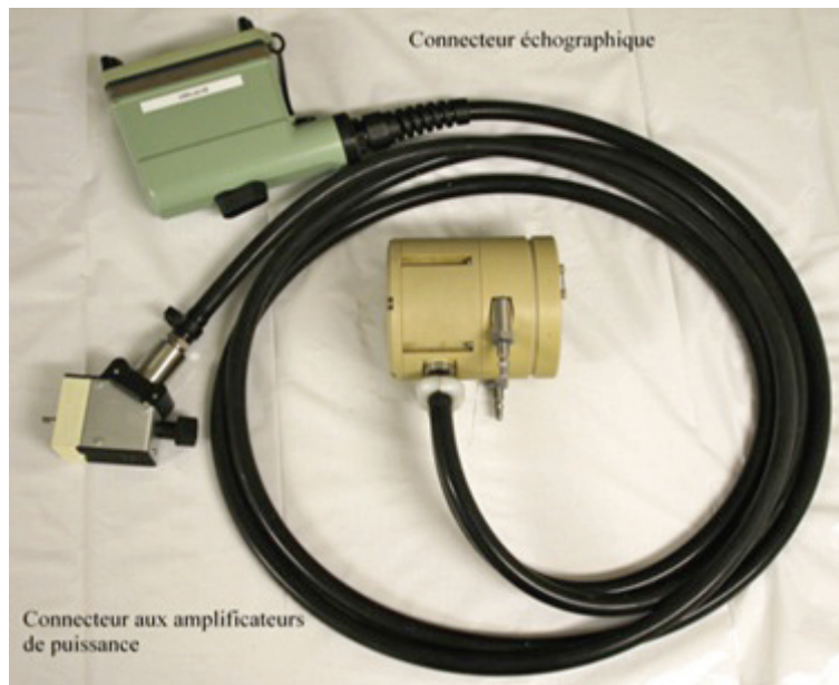
Figure 15 : Vue d'ensemble de la sonde torique. La sonde est munie d'un connecteur pour l'échographe et d'un connecteur permettant la liaison aux amplificateurs de puissance.
