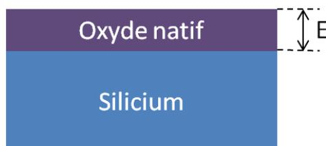
Figure IV-4 : Modélisation de la structure  $\text{SiO}_2/\text{Si}$
