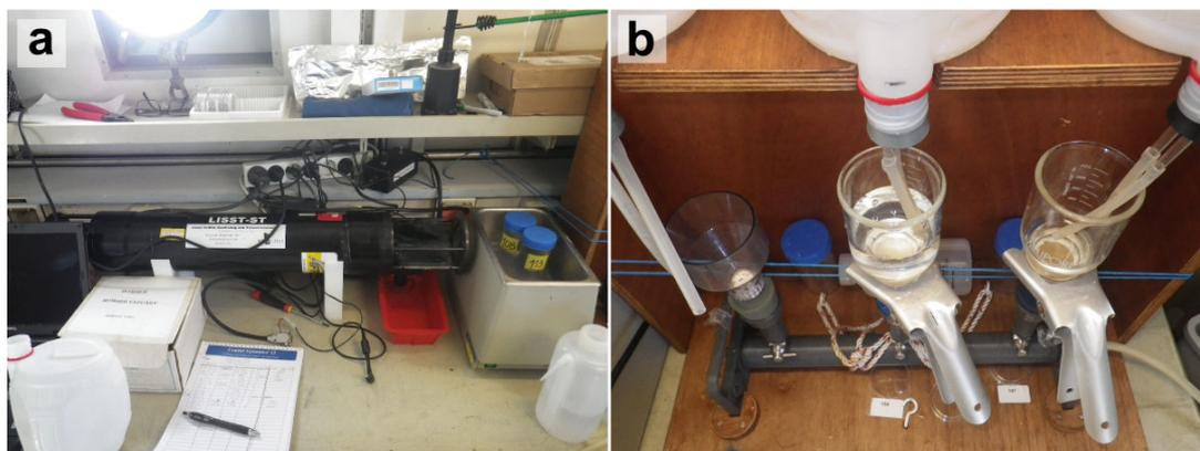
Figure 3 : (a) LISST-100X et échantillons passés à la cuve à ultrasons. (b) Banc de filtration.
