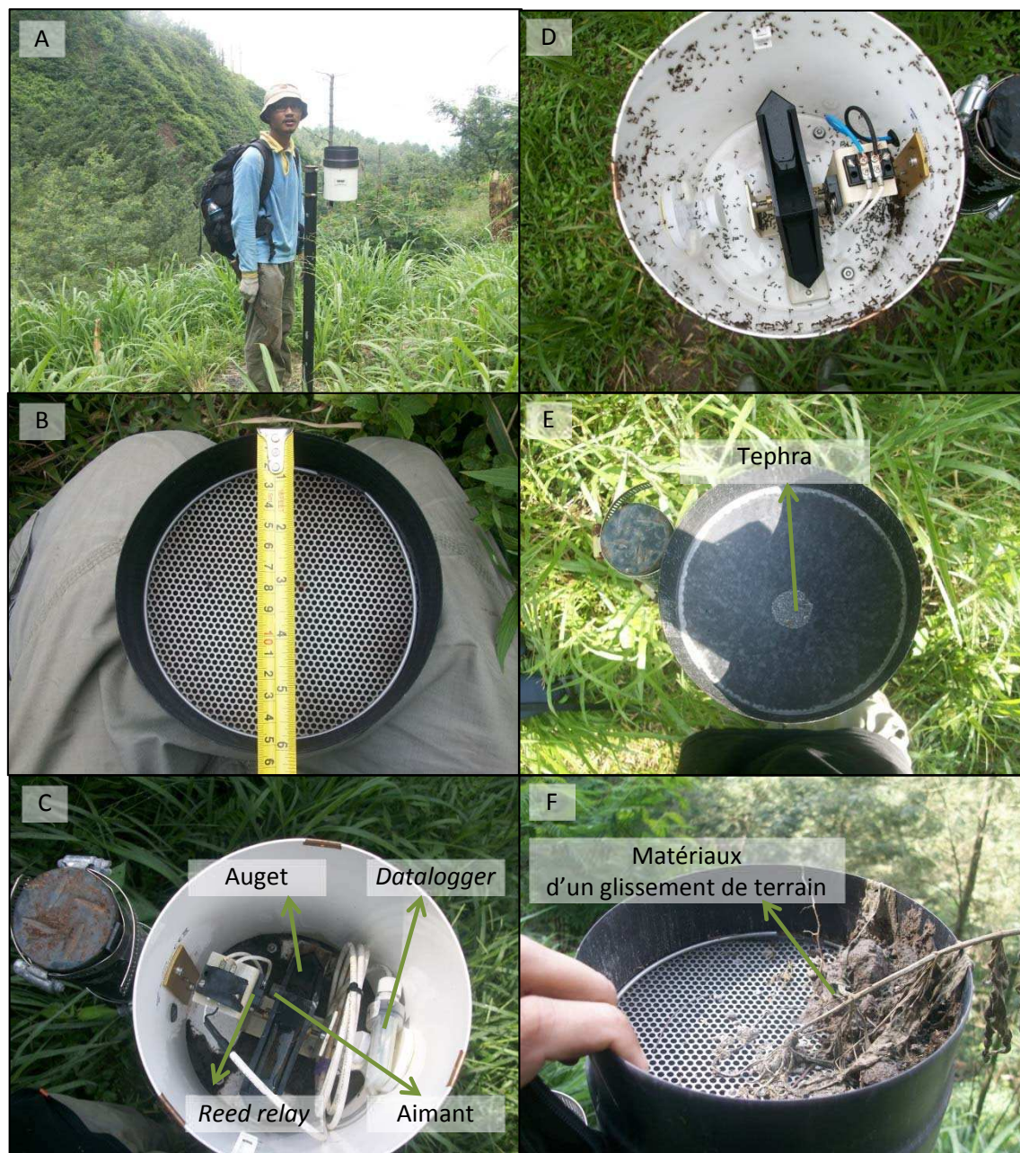
Figure 16 - Pluviomètres utilisés dans cette étude. (A) Installation du pluviomètre au sommet d'un mât de 1,5 m de hauteur ; (B) Couverture du pluviomètre composé d'un tamis de 15,5 cm en diamètre et d'un entonnoir ; (C) Composants à l'intérieur d'un pluviomètre ; (D) Dérangement par les insectes ; (E) Bouchage de l'entonnoir par des tephras suite à une éruption phréatique mineure ; (F) Matériaux d'un glissement de terrain sur le tamis.
