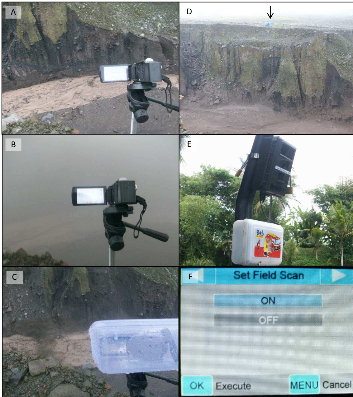
Figure 17 - Installation de caméra et d'appareil photo. (A) Caméra sur la rive droite; (B) Chenal invisible à cause de brouillard; (C) Caméra dans une boîte en plastique lors d'un lahar; (D) Vue de la rive gauche montrant l'appareil photo automatique à côté de la station sismique; (E) Appareil photo automatique sur un mât; (F) Fonction scanner de l'appareil photo.
