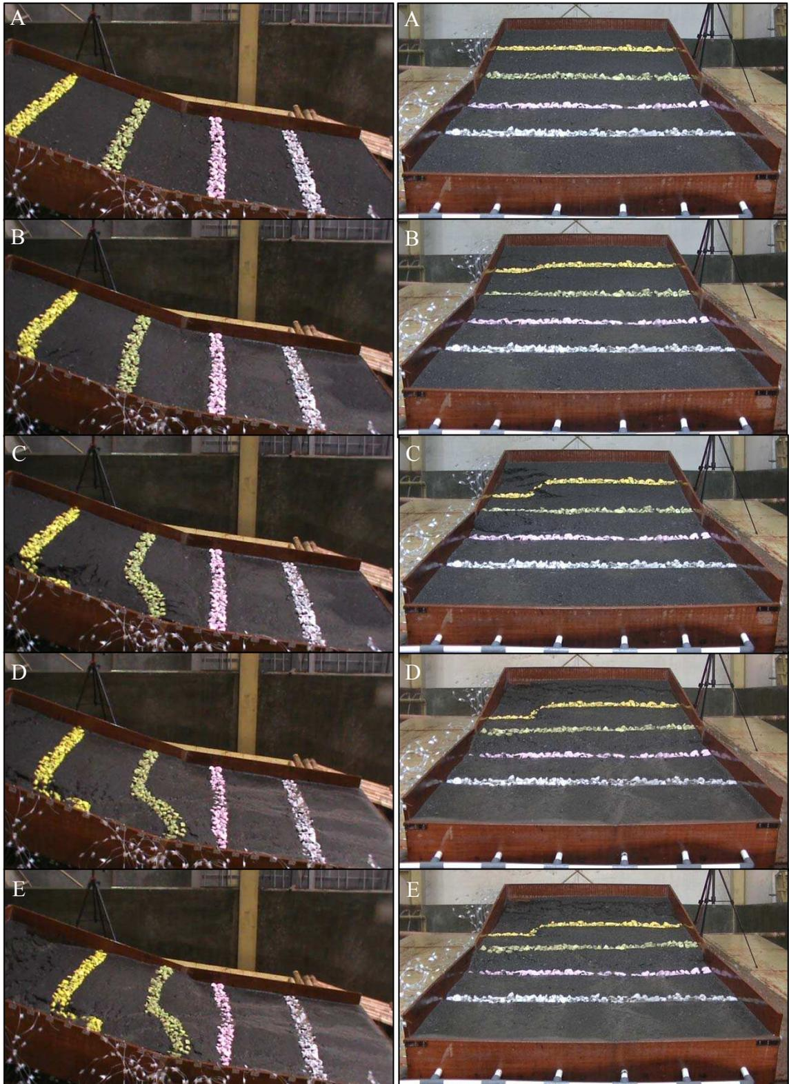
Figure 40 - **Glissement de terrain de la simulation 2.** L'intervalle de temps de (A) à (E) fut de 3 minutes 6 secondes. La première phase (A à C) et la deuxième phase (D à E) durèrent 3 secondes. La position stable entre les deux dura 3 minutes.
