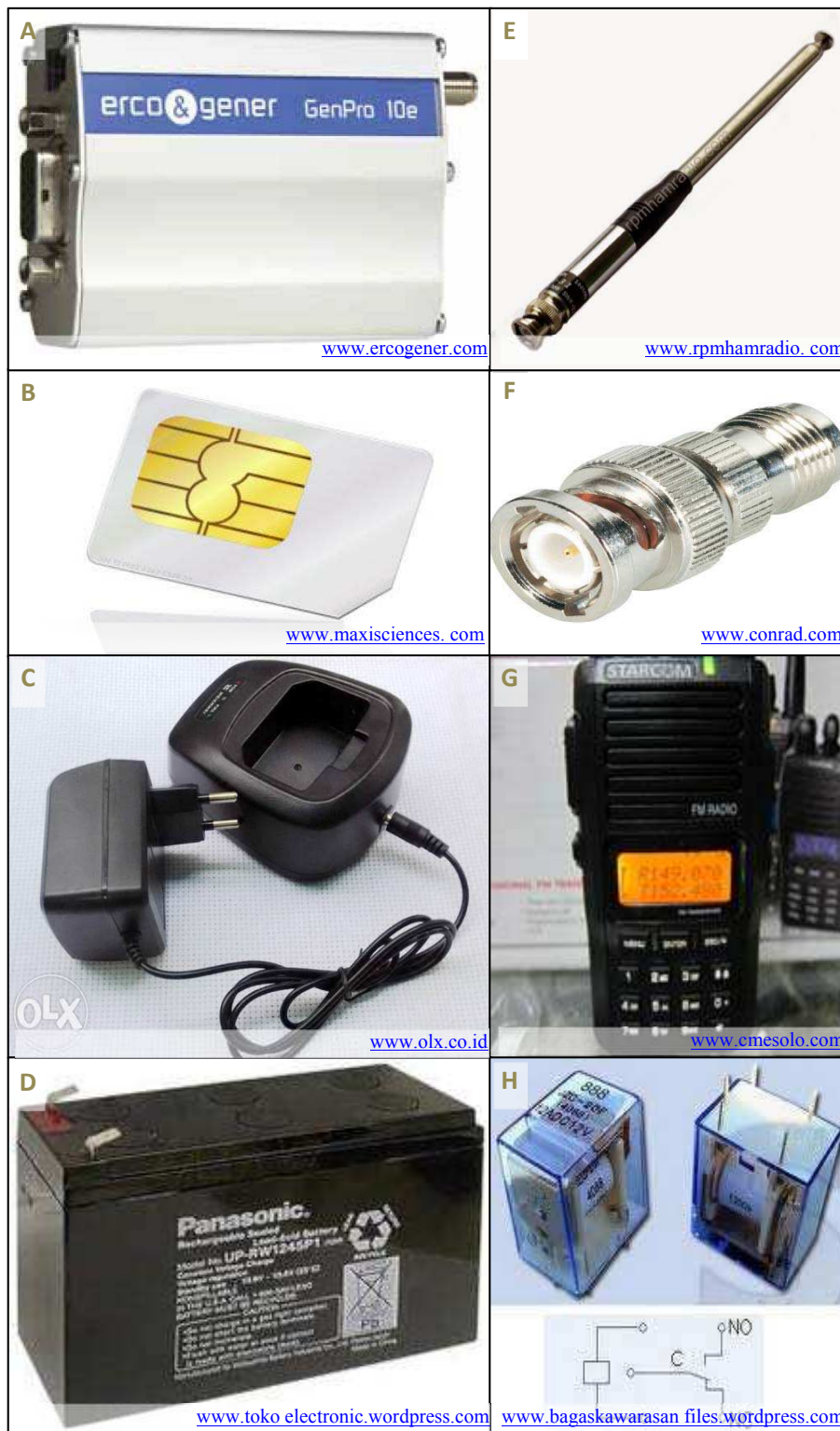
Figure 15 - Instruments de surveillance indépendante. (A) Modem GSM; (B) Carte SIM; (C) Système d'alimentation; (D) Batterie; (E) Antenne NH-31; (F) Connecteur BNC; (G) Radio communication; (H) Relais
