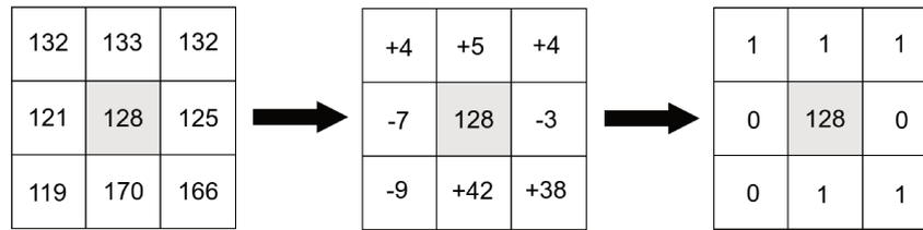
FIGURE 2.14 – Exemple de construction d'un vecteur binaire LBP : calcul de la différence du pixel central avec ses 8 voisins puis seuillage (0 ou 1) en fonction du signe de la différence.
