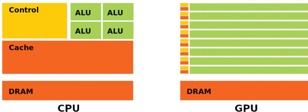
FIGURE 3.16 – Architectures classiques d'un CPU et d'un GPU. Le GPU se distingue par un grand nombre d'unités arithmétiques et logiques. (Nvidia)
