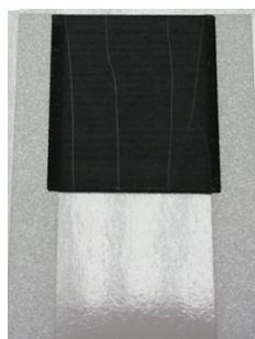
FIGURE 5.4 – Observation de fissures sur les éléments chauffants sérigraphiés sur support papier.
