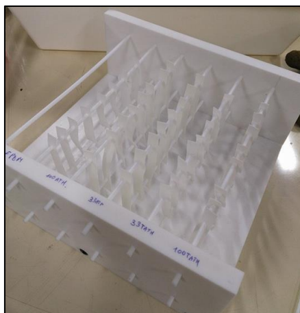
Figure 6 : Porte-échantillon utilisé lors du vieillissement thermo-oxydatif en étuve ventilée.
