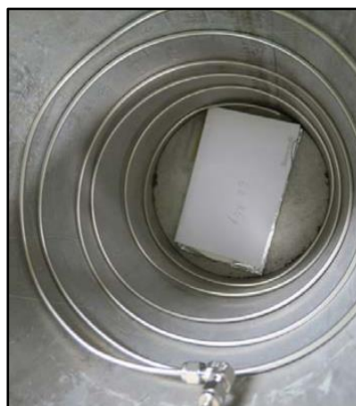
Figure 7 : Photographie de l'intérieur du container d'irradiation. Les échantillons sont visibles dans le fond, séparés par des feuilles d'aluminium.
