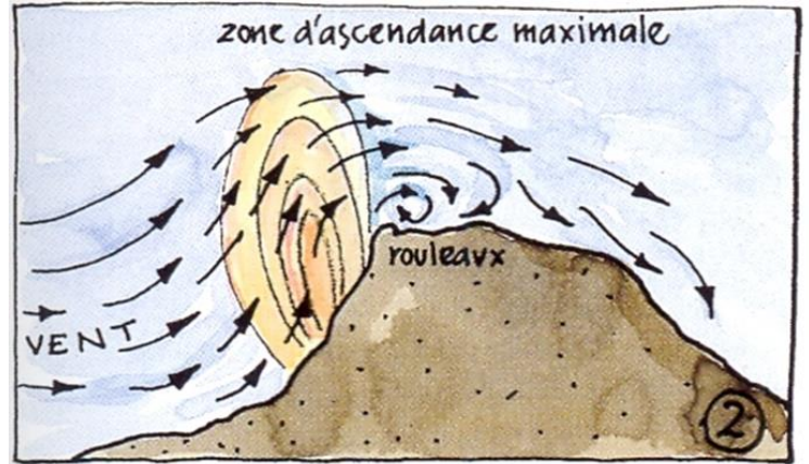
Figure 3.2. Principe de formation des ascendances orographiques. A la rencontre d'un obstacle, ici un relief montagneux, le vent s'élève dynamiquement le long de la pente. Source des illustrations : Mouze 1998
