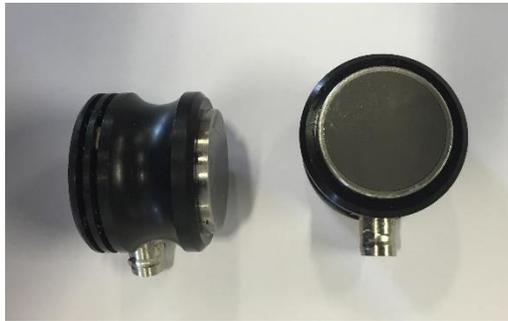
**Figure 3-10. Capteurs d'ondes de cisaillement**
