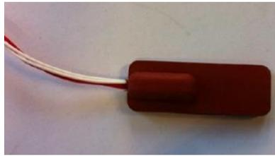
Figure 3-4. Sonde de température de type PT100
