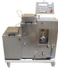
**Figure 2-4. Extracteur automatique de bitume**
