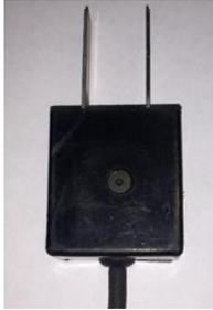
**Figure 3-18. Capteur d'ouverture de fissure de type CMOD**
