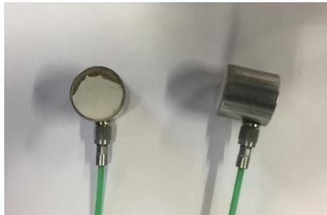
**Figure 3-9. Capteurs d'ondes de compression**
