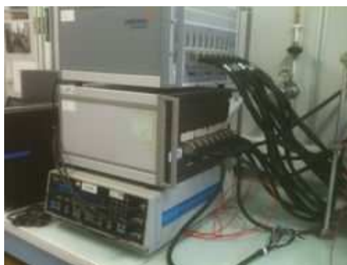
Figure 2. Potentiostat-galvanostat Solartron utilisé pour la caractérisation électrochimique de \gamma -V 2 O 5 .
