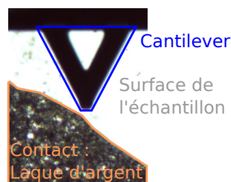
FIGURE 4.24 – Image de microscopie optique de la position de la pointe par rapport à la surface de l'échantillon.
