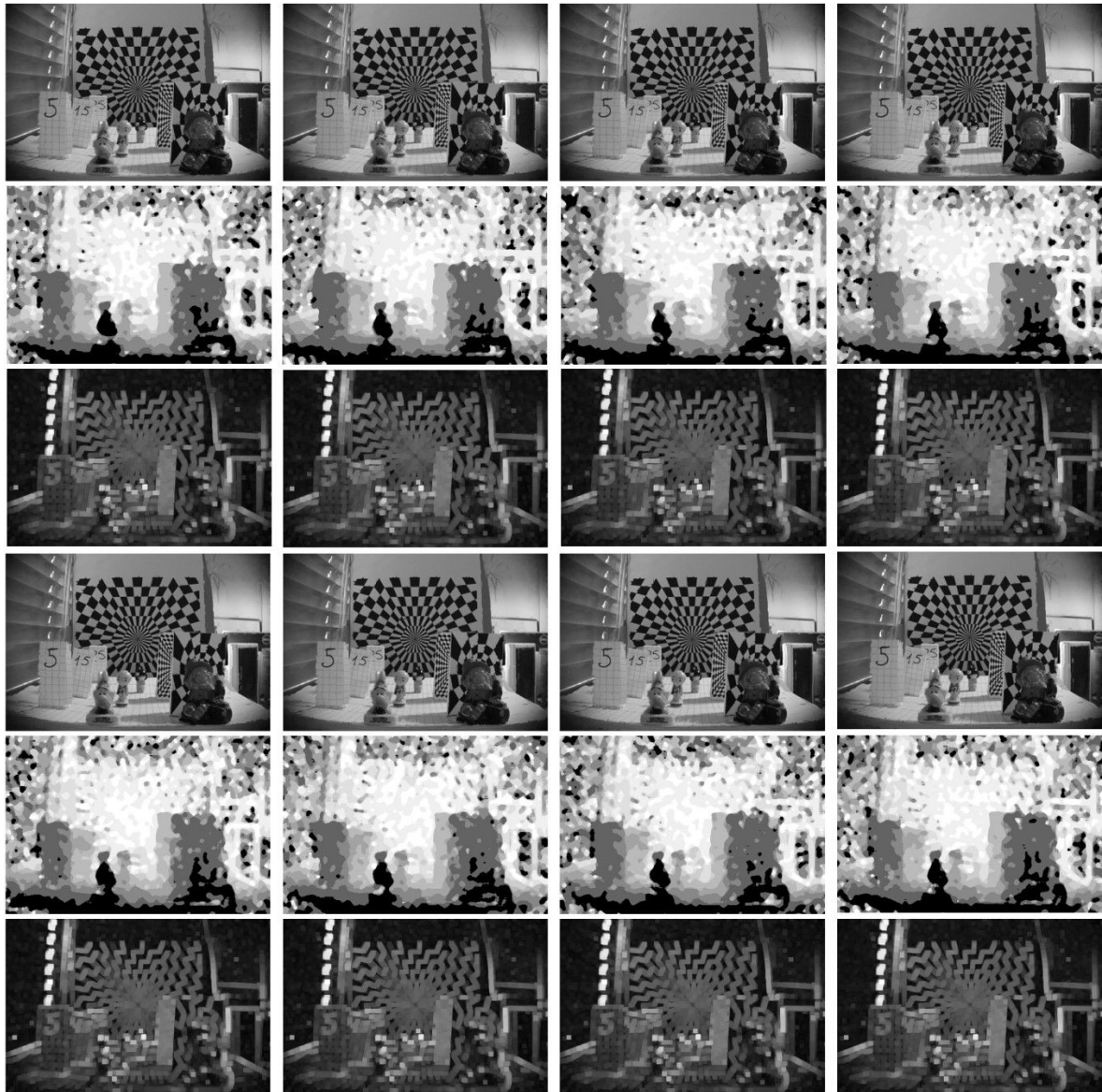
FIGURE 88: EVOLUTION TEMPORELLE, DANS LE SENS DE LECTURE, DES IMAGES AIF, DES CARTES DE PROFONDEURS ET DE CONFIANCES POUR DES FENETRE DE TRAITEMENT 9×9 ET UNE FILTRE MEDIAN DE NOYAU 11×11
