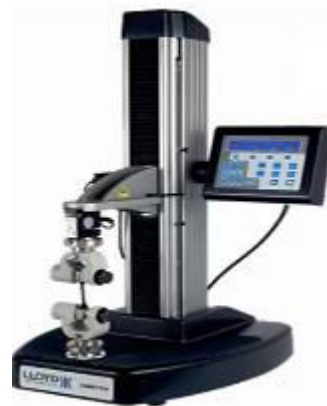
Figure 27 : Photo d'un texturomètre à compression utilisé en analyse sensorielle (Photo : https://www.google.fr/search?q=texturomètre&source )
