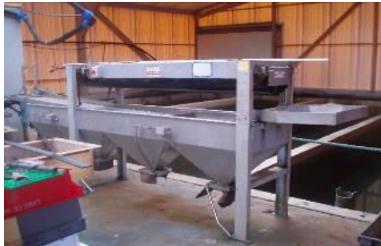
Figure 19 : Cribleuse ostréicole en eau utilisée pour un tri par la taille de juvéniles inférieurs à 30 mm (Photo : SCEA France Haliotis)
