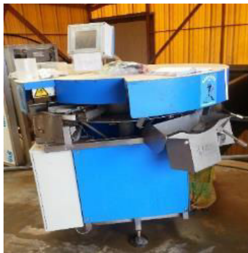
Figure 25 : Calibreuse de France Haliotis permettant la pesée de 900 individus par heure
