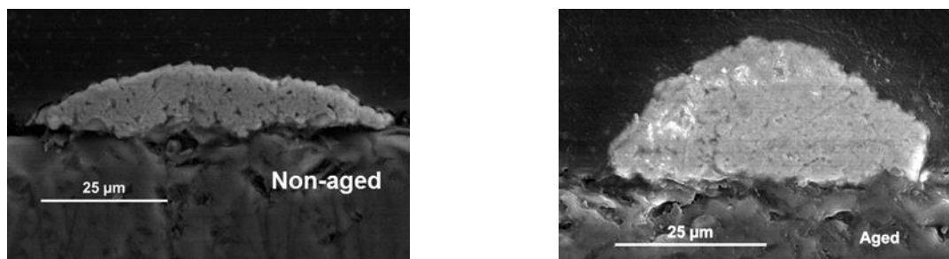
Figure IV.10. Images MEB en coupe transversale des doigts de contact sérigraphiés en argent avant et après exposition à une dose UV de 199,8 kWh/m 2 .
