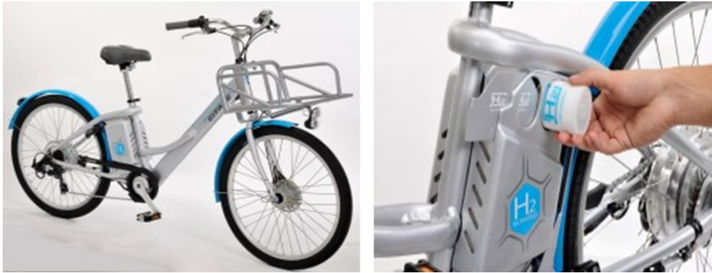
Figure I.13: Le premier VAE fonctionnant à l'hydrogène: le VAE Gitane Alter Bike.
