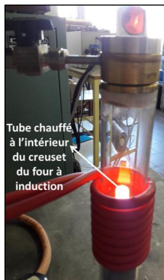
Figure II.2: Photo du four à induction (pris lors de la fusion).
