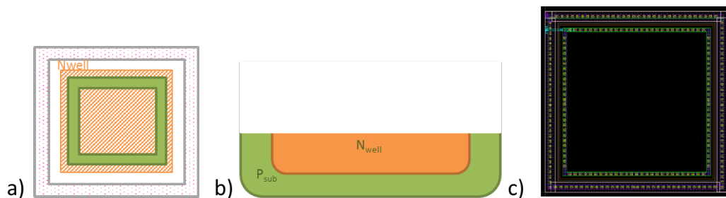
Figure 2-26: Photodiode de modèle N_{\text{well}}P a) schéma layout vu de dessus b) vue en coupe c) layout
