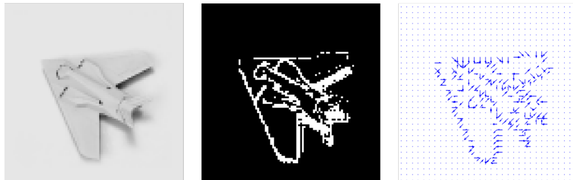
Figure 4-12: de gauche à droite: image originale, image binaire, orientations et intensités des gradients calculés grâce à la carte binaire
