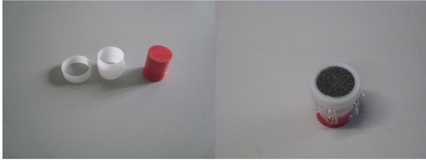
FIG. 5.3: Porte-échantillons du P-XRF adapté pour les expériences HEPIXE. A gauche vide, a droite rempli de sable.
