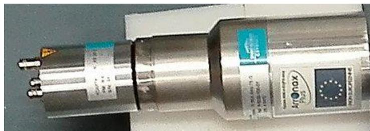
FIG. 2.18: Photo du détecteur  $\text{LaBr}_3 : \text{Ce}$
