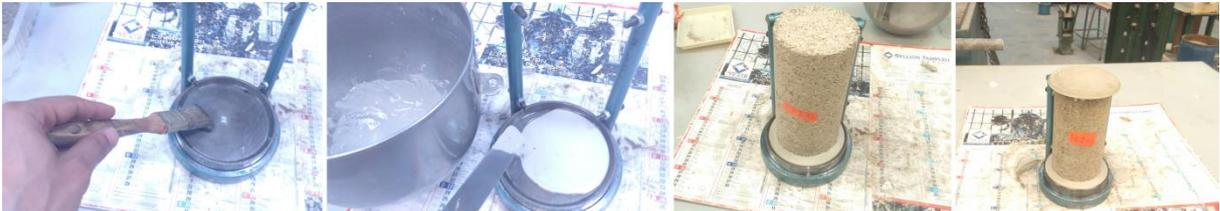
**Figure II-1 : Surfacage des échantillons**
