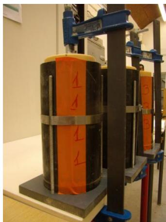
**Figure V-5 : Utilisation des serre-joints pour limiter le phénomène de décompaction**
