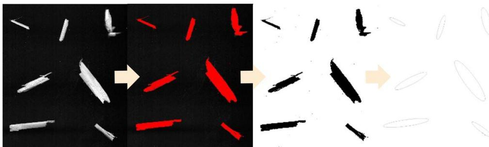
**Figure III-22 : Protocole d'analyse granulométrique par traitement d'image (Scan, binarisation de l'image, conversion l'échelle de gris et ajustement sous forme des ellipses).**
