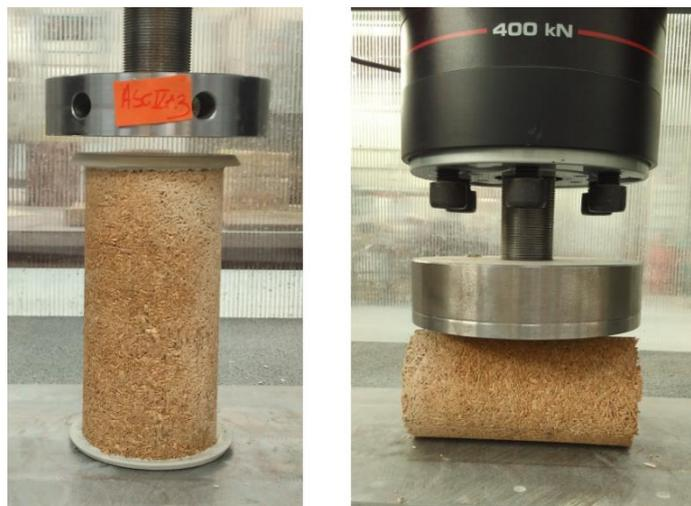
Figure II-3 : Dispositifs expérimentaux - à gauche: essai de compression, à droite: essai de traction par fendage.
