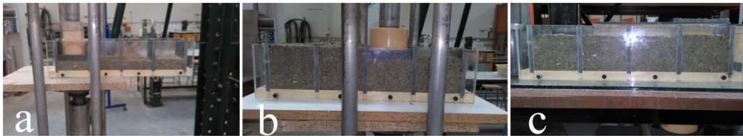
**Figure V-3 : Mise en forme des échantillons prismatiques : a) compactage de la première couche ; b) compactage de la deuxième couche ; c) état final**
