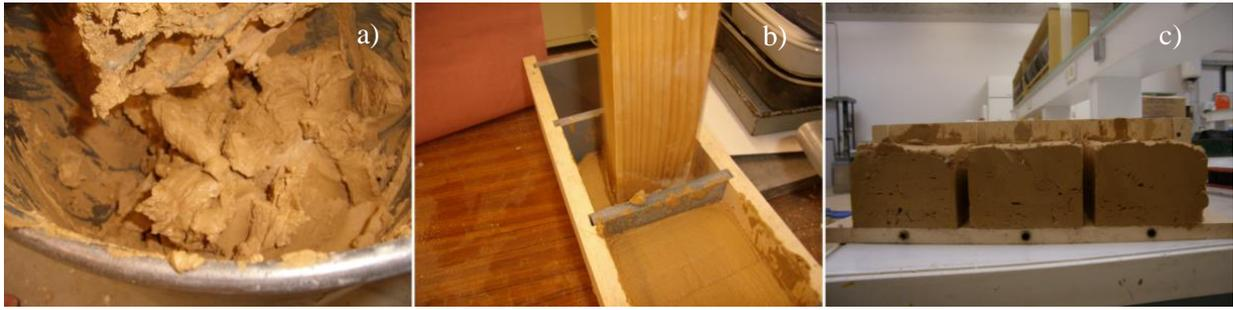
**Figure IV-14 : Fabrications des échantillons de fines issues de la boue de lavage : a) malaxage b) pilonnage c) démoulage**
