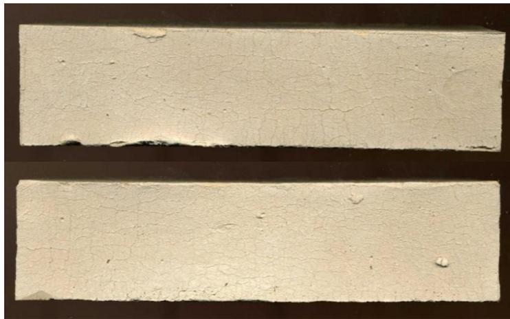
Figure IV-19 : Échantillons de fines stabilisées par le couple chaux-métakaolin : faïençage important
