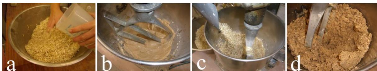
**Figure V-2 : Séquence de malaxage : a) pré-mouillage du chanvre et malaxage à la main; b) mélange du liant; c et d) addition du chanvre humide et malaxage**
