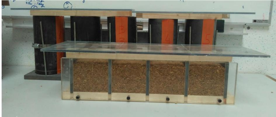
Figure V-7 : Conservation des échantillons à l'air ambiant
