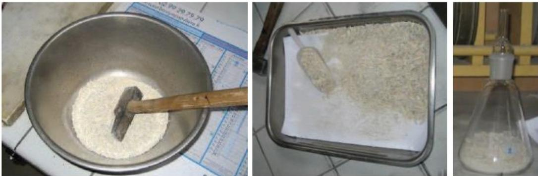
**Figure III-25 : Broyage et mise en place – méthode pycnométrique**
