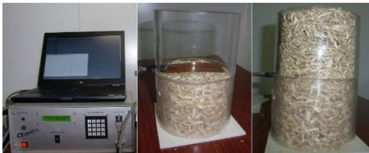
**Figure II-12 : Mesure de conductivité thermique du chanvre en vrac avec le CT-mètre.**
