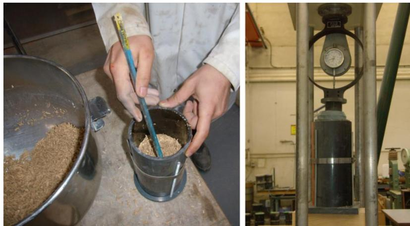
**Figure V-4 : Mise en forme des échantillons cylindriques**
