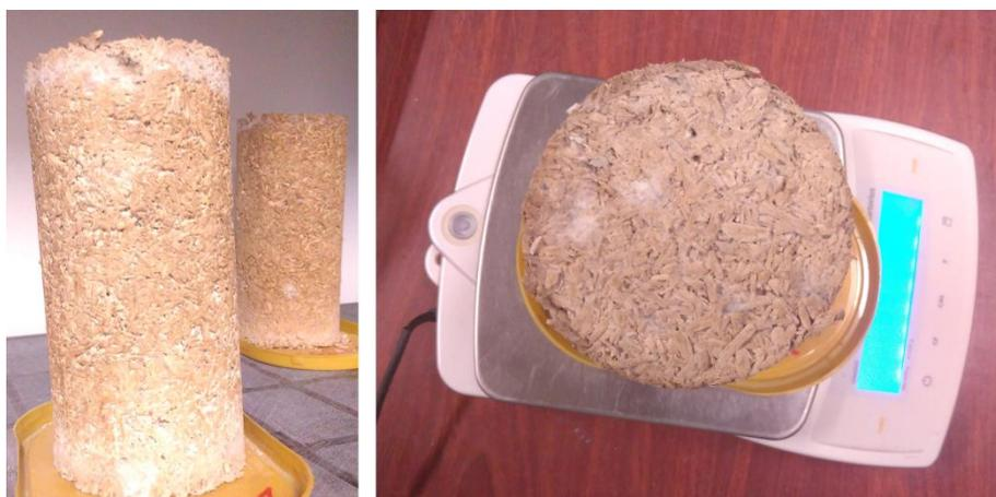
**Figure V-6 : Apparition de moisissures sur les échantillons**
