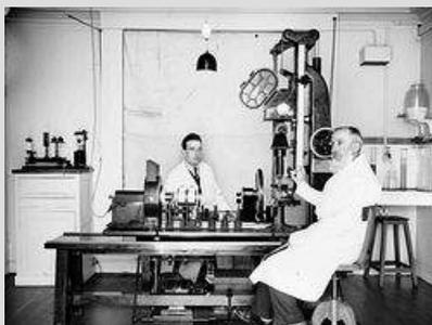
Fig. 60. Caméra sur microscope de Jean Comandon (vers 1931) © CNRS
