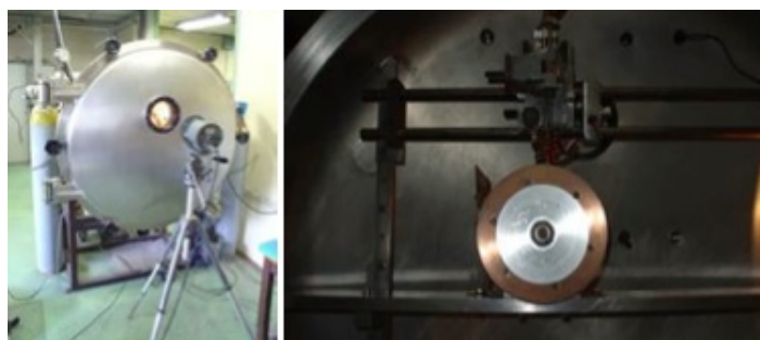
Figure E.3.: A gauche: le système complet de trempe rapide ( melt spinning ). A droite : intérieur de l'appareil avec une roue en cuivre faiblement allié au béryllium-cobalt de 20 cm de diamètre, au-dessus de la roue emplacement de la buse et système haute fréquence permettant de mettre en fusion l'alliage. La température de l'échantillon est contrôlée par un pyromètre optique.
