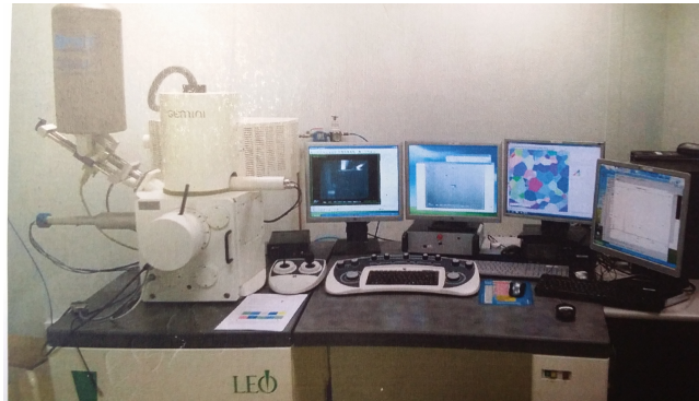
Figure E.19.: Microscope électronique à balayage Zeiss Leo 1530 équipé d'un détecteur EBSD au laboratoire de métallurgie structurale à l'ENSCP utilisé pour faire nos clichés EBSD
