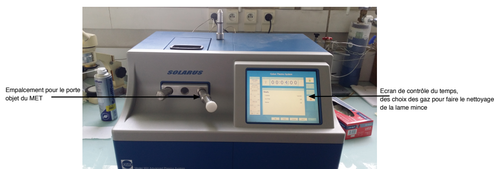
Figure E.15.: Plasma cleaner pour nettoyer la surface des lames minces
