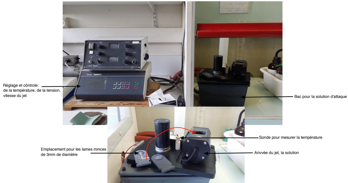
Figure E.13.: Tenupol Struers utilisé pour faire un trou mince pour observation au microscope électronique.
