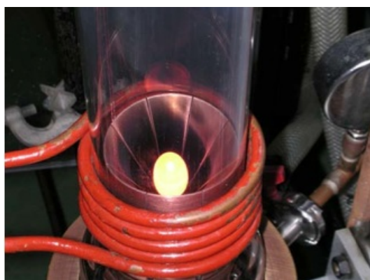
Figure E.1.: Fusion en semi-lévitation sous atmosphère d'hélium. La spire en forme de bobine transmet le champ magnétique par induction et crée un intense courant de Foucault dans l'échantillon ce qui permet la fusion de l'alliage par effet Joule dans un temps très court.
