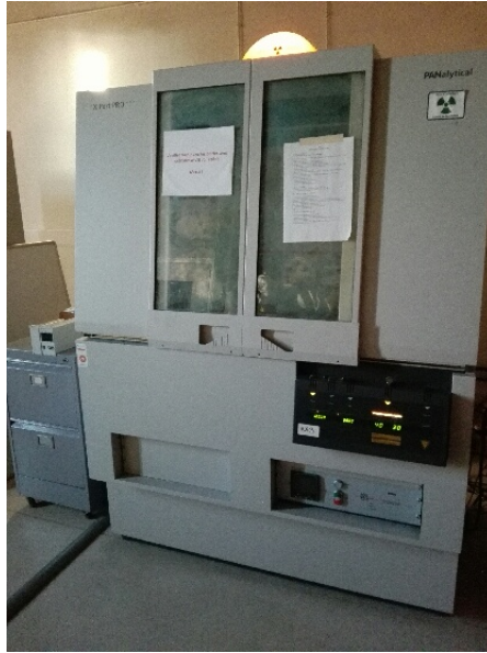
Figure E.16.: Diffractomètre Xpert Pro Panalytical utilisé pour faire la DRX sur nos échantillons
