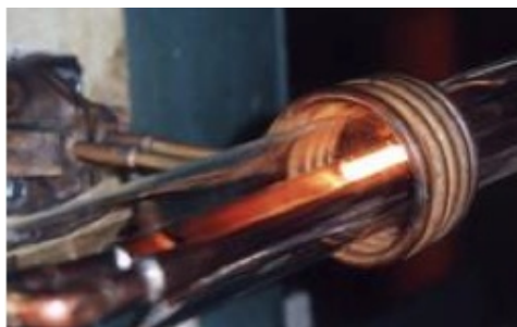
Figure E.2.: Fusion sur nacelle de cuivre sous atmosphère d'hélium utilisée pour l'élaboration du Ru_{13}Sc_{57} .
