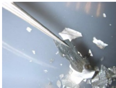
Figure E.4.: Forme finale de l'échantillon : rubans et paillettes après trempe.
