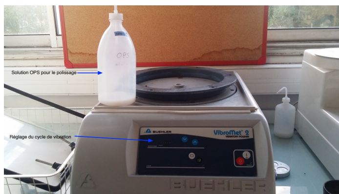
Figure E.12.: Vibromètre utilisé pour le polissage miroir de nos échantillons.
