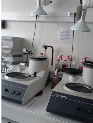
*Figure E.10.: Bancs de polissage mécanique.*
