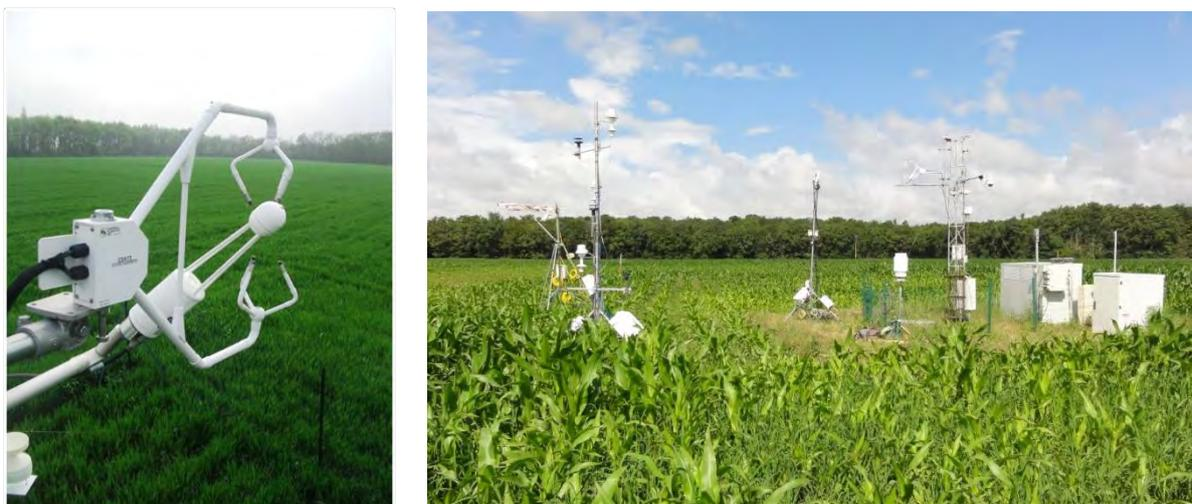
Figure 1-2: Photographies de l'anémomètre sonique et des mâts de mesures installés sur la parcelle de Lamothe (Photos © CESBIO).
