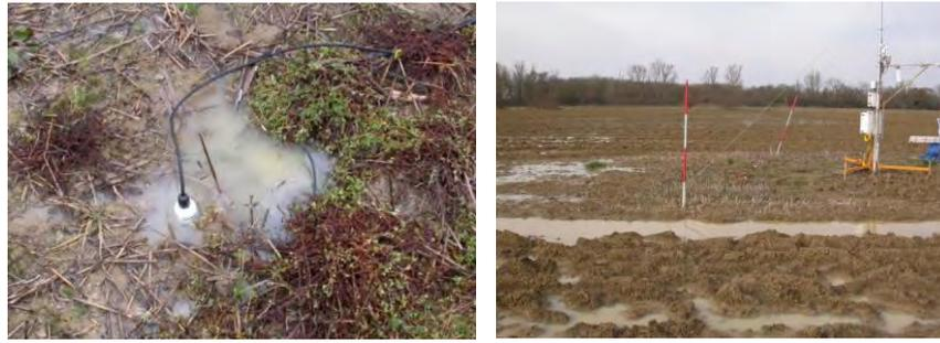
Figure 3-28: Photographies de la parcelle de Lamothe le 18 février 2014 et de la sonde Tetraprobe mesurant l'humidité du sol (0-5 cm) (Photos © CESBIO).
