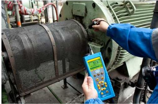
FIGURE 1.20 – *Mesure par ultrason*
