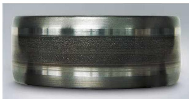
FIGURE 2.27 – Corrosion électrique d'une bague de roulement (NSK)
