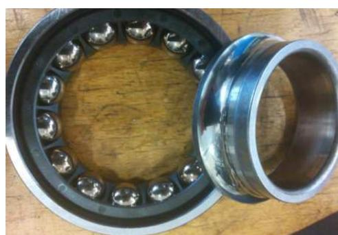
FIGURE 2.26 – Roulement démonté testé électriquement après 6 mois d'utilisation
