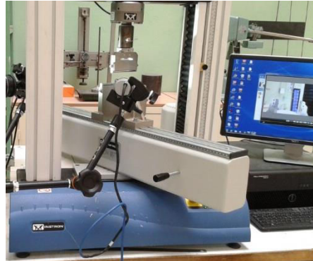
Figure III.23 : Machine électromécanique utilisée pour effectuer les essais de flexion trois points
