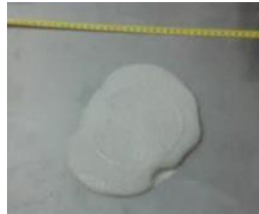
Figure 3 : Etalement au mini-cone du mortier de laitier activé (sans citrates de sodium)
