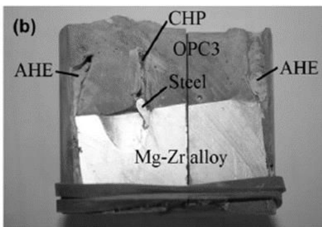
Figure II.30 : Test de dégagement d'hydrogène sur ciment Portland OPC3 avec un rapport de surface entre la cathode et l'anode de 0,1 (AHE pour production d'hydrogène anodique et CHP pour production cathodique d'hydrogène) (Rooses, 2013)
