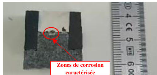
Figure IV.49 : Echantillon de corrosion galvanique et zone de corrosion analysée par nano-indentation
