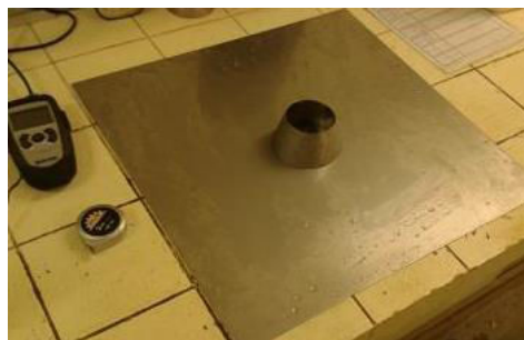
Figure 1 : Mesure de l'étalement du mortier de laitier activé au mini-cône
