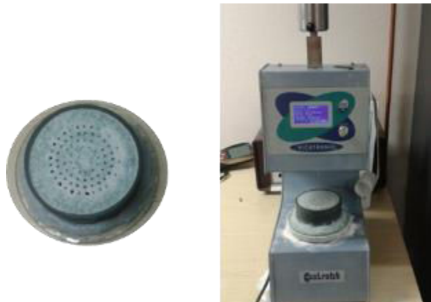
Figure III.20 : Appareil à aiguille Vicat utilisé pour déterminer le temps de début de prise du matériau
