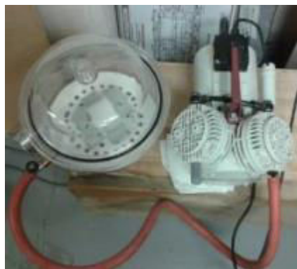
Figure III.4 : Montage de pompe à vide pour évacuer l'air présent dans la porosité du matériau
