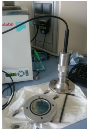
Figure III.37 : Dispositif de suivi de l'humidité relative interne dans le mortier de laitier activé
