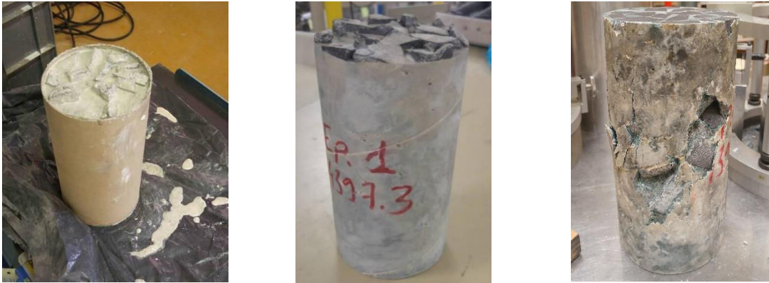
Figure V.12 : photos des éprouvettes de mortier de laitier activé avec 45% volumique de graphite utilisées pour mesurer le module de Young statique à 28 jours (compression uni-axiale avec extensomètre) – essai jusqu'à rupture
