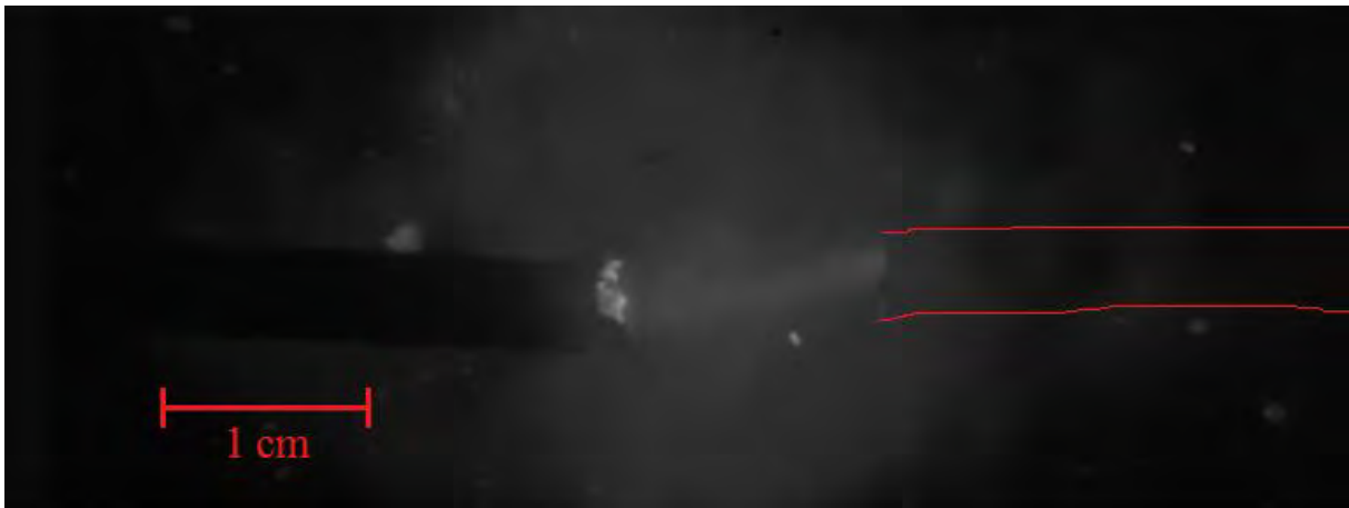
Figure IV-3. Photo de l'arc lors d'un test de détermination de la chute de tension aux électrodes, pour des câbles aluminium, à 174 A et à 95 mbar. Cette image correspond à un temps d'arc de 490 ms. Le temps d'exposition est de 30 \mu s.
