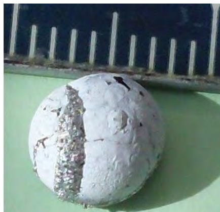
Figure III-2. Gouttelette de métal éjectée après un essai avec des câbles aluminium.
