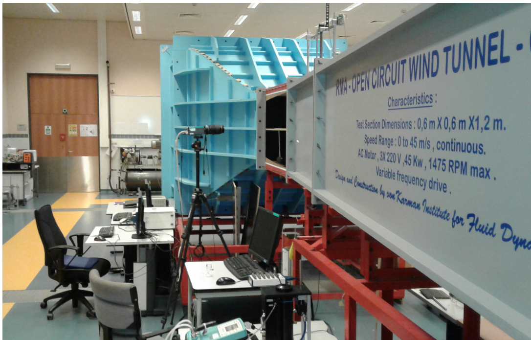
FIGURE 5.12 – Banc expérimental pour la calibration de la sonde en proche paroi
