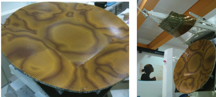
FIGURE 1.2 – Exemple de RA de 1,3 m constitué de 5 panneaux pour une mission de télécommunications en bande Ku.
