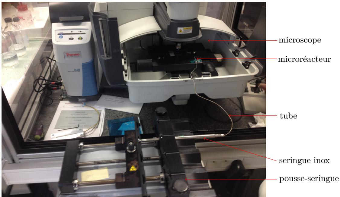
FIGURE 3.9: Connection entre le pousse-seringue et la puce microfluidique : le microréacteur est ici placé sous un microscope.
