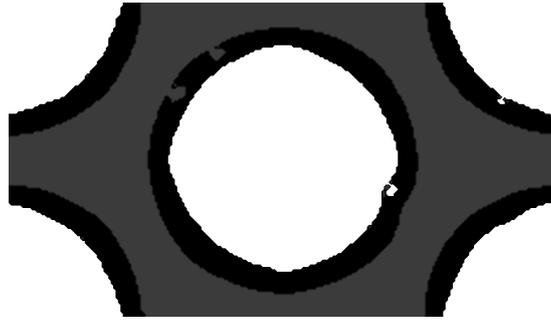
FIGURE 2.18: Génération de l'image tridimensionnelle de la cellule du GLoC : les plots ont la forme d'un tronc de cône.
