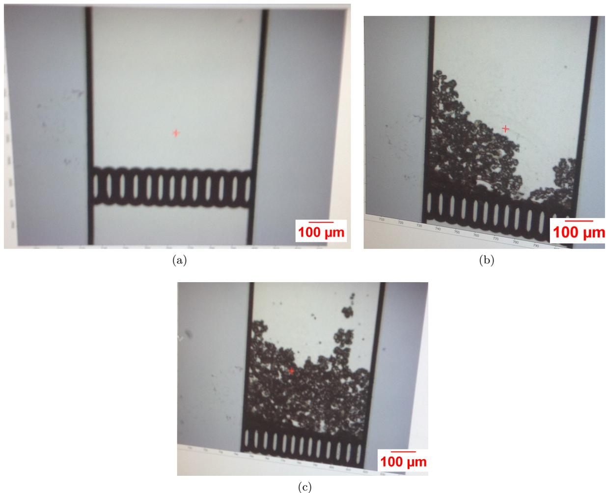
FIGURE 3.13: Évolution du chargement dans le microréacteur à différents instants de l'injection de la suspension : 3.13a) état du chargement à  $t=0$  - 3.13b) état du chargement à  $t=2$  min - 3.13c) état du chargement  $t=4$  min.
