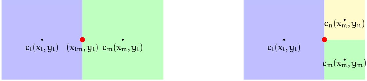
FIGURE 2.6: Configurations possibles sur le positionnement des mailles où l'approximation du flux doit être faite au point coloré en rouge. À gauche, les mailles adjacentes sont de même niveau. À droite, les mailles adjacentes ne sont pas de même niveau.
