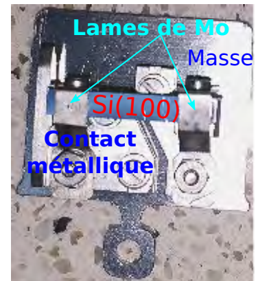
(b) Échantillon de silicium monté sur un porte-échantillon à courant direct. Celui-ci est maintenu sur son support à l'aide de lames de Molybdène. Le contact métallique indiqué sur le schéma n'est pas en contact avec la masse.
