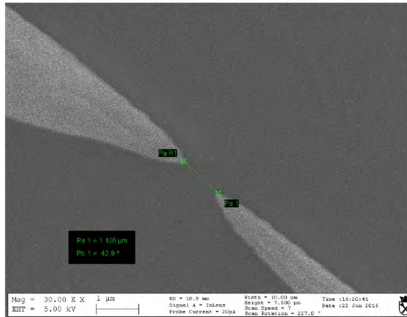
FIGURE 8.1 – Image SEM réalisée sur le 4-STM avec les paramètres indiqués (5kV ; 20pA). La distance inter-pointes ici est de 1,1μm, sur Si(100) :H-(2×1) .
