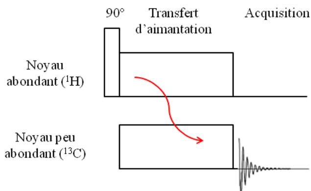
Figure A-5 : Séquence d'impulsions d'une expérience CPMAS.
