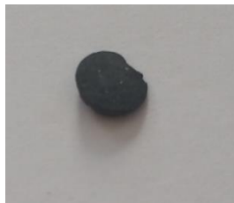
Figure 6. Poudre commerciale de CuO après ATG.
