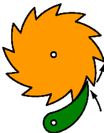
Figure 2 Une roue à rochet macroscopique dont le mouvement mécanique orienté est assuré par le blocage de la roue crantée (orange) par le cliquet (vert) dans le sens horaire. La rotation dans le sens antihoraire est par contre permise.
