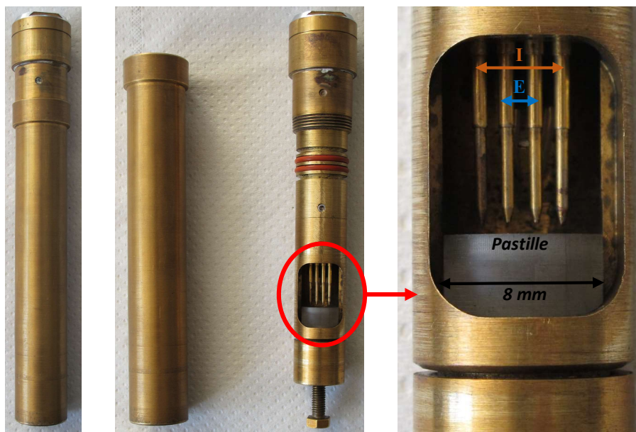
Figure II-6 : Cellule étanche à l'air pour les mesures de conductivité électrique à basse température par la méthode des quatre pointes.
